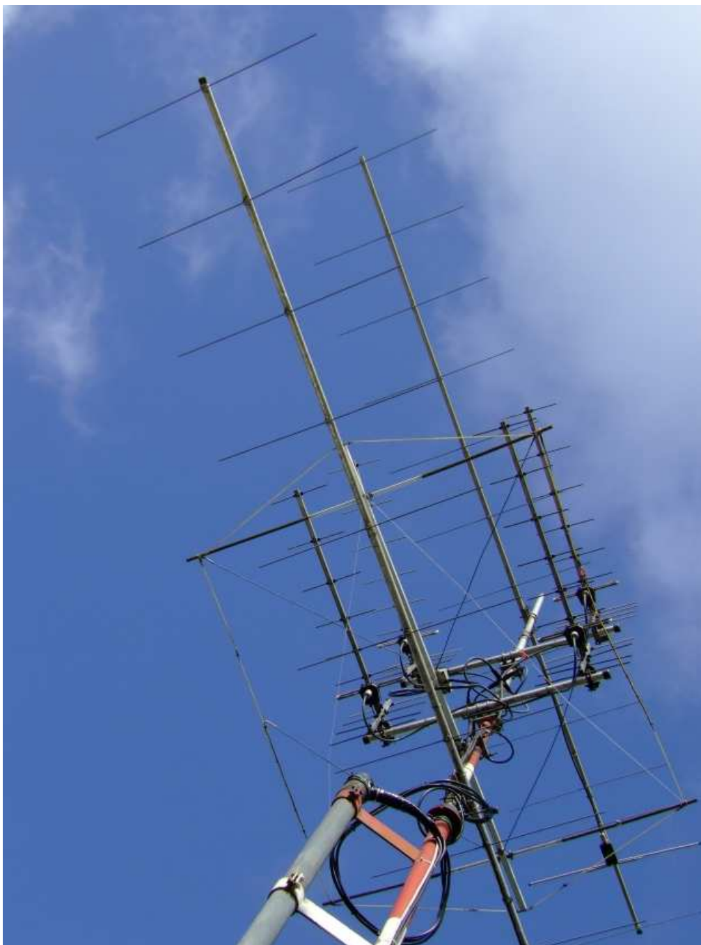
Bild 10: Der Doppel-M-Beam, eingefügt in eine Antennengruppe aus zwei 2m-Langyagi und vier 70cm-Yagi
